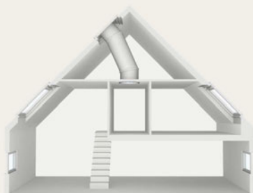
Светлинен тунел с гладка тръба за скатен покрив
