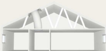
Светлинен тунел с гъвкава тръба за скатен покрив
